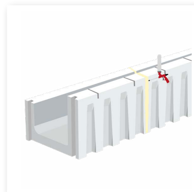
Afbelding V.08 Breng PUR-schuim aan.
