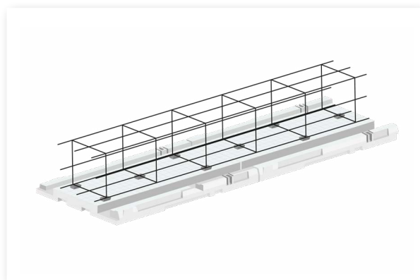
Afbeelding D.03 Wapening aanbrengen
