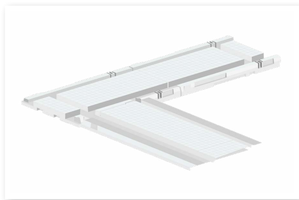
Afbeelding D.01 Start met het plaatsen van de hoeken
